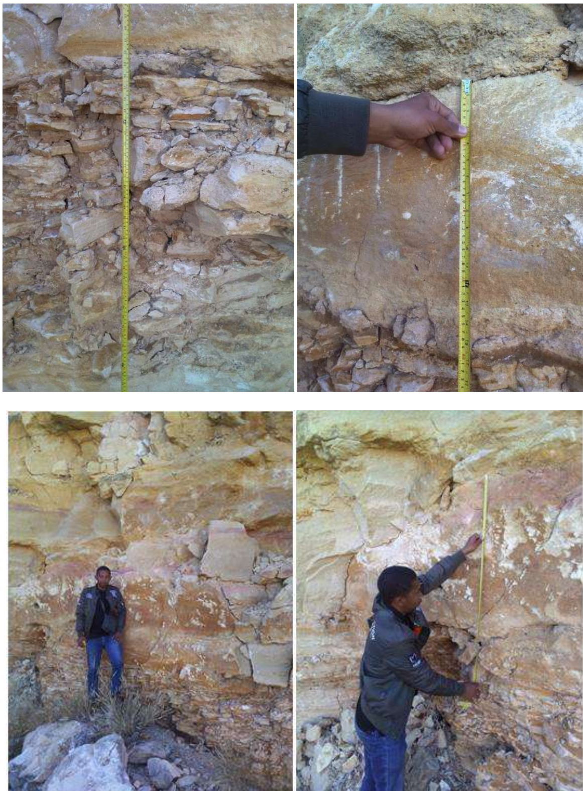
Figure 10 : Mesure de l'épaisseur des bancs de calcaire
