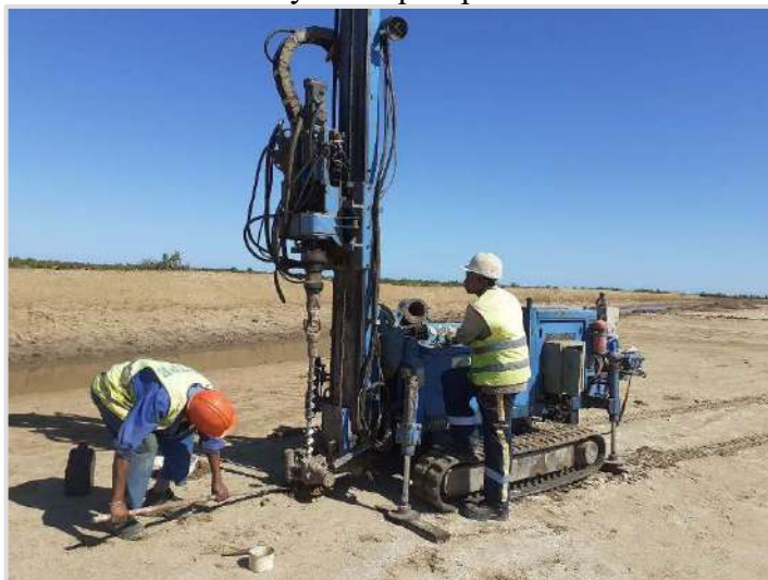
Photo 5: Sondage à la tarière mécanique
