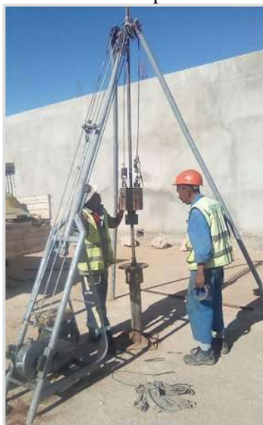
Photo 2 : Sondage au pénétromètre dynamique de type B1
