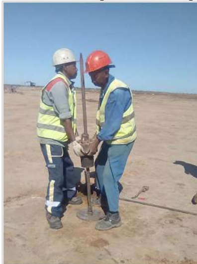
Photo 4: Prélèvement d'échantillon intact (PEI)
