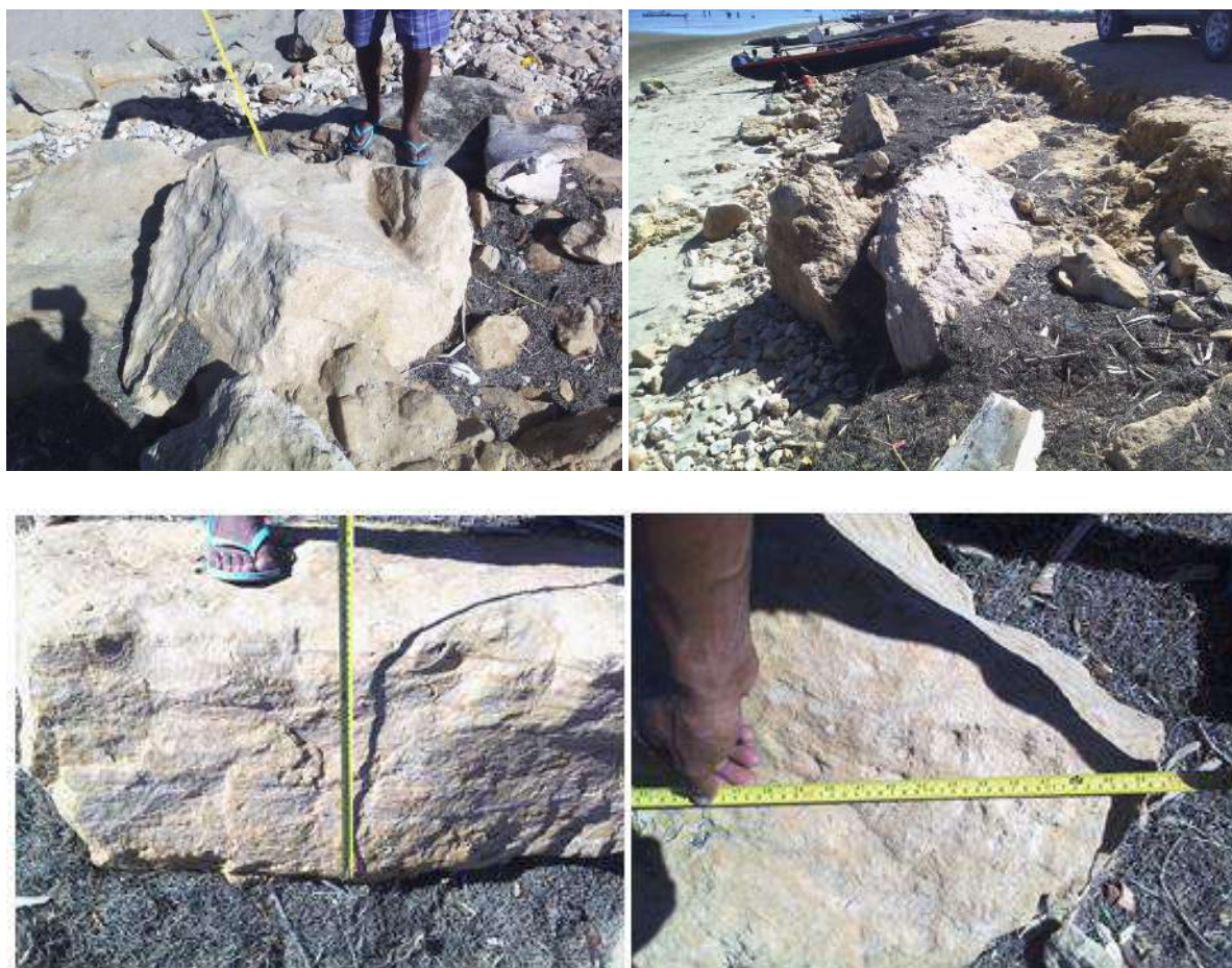
Figure 13 : Exemple de mesure des enrochements sur l'ancienne digue
