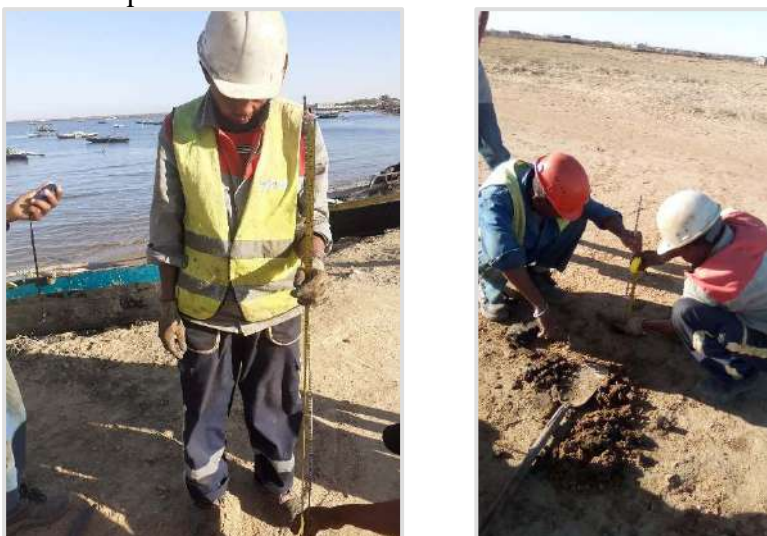
Photo 6: Essai de perméabilité Lefranc
