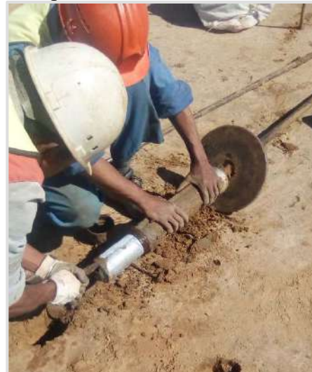
Photo 4: Prélèvement d'échantillon intact (PEI)
