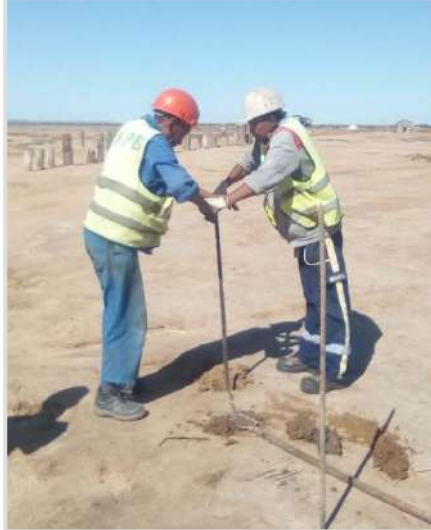
Photo 3: Sondage à la tarière manuelle
