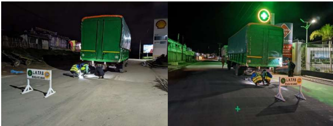
Photo 1 : Mesure de déflexion
