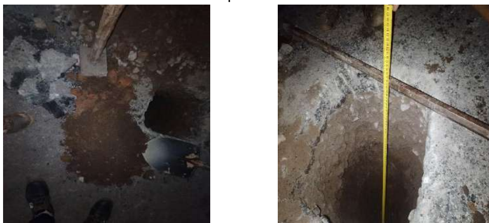
Photo 2 : Sondage sous-chaussée
