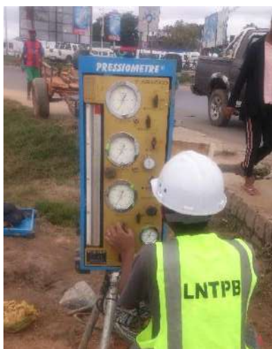
Essai pressiométriques
