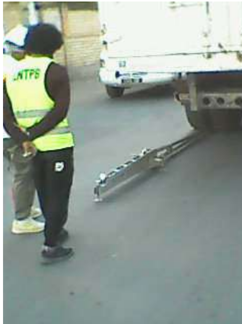
Photo 2 : Mesure de déflexion
